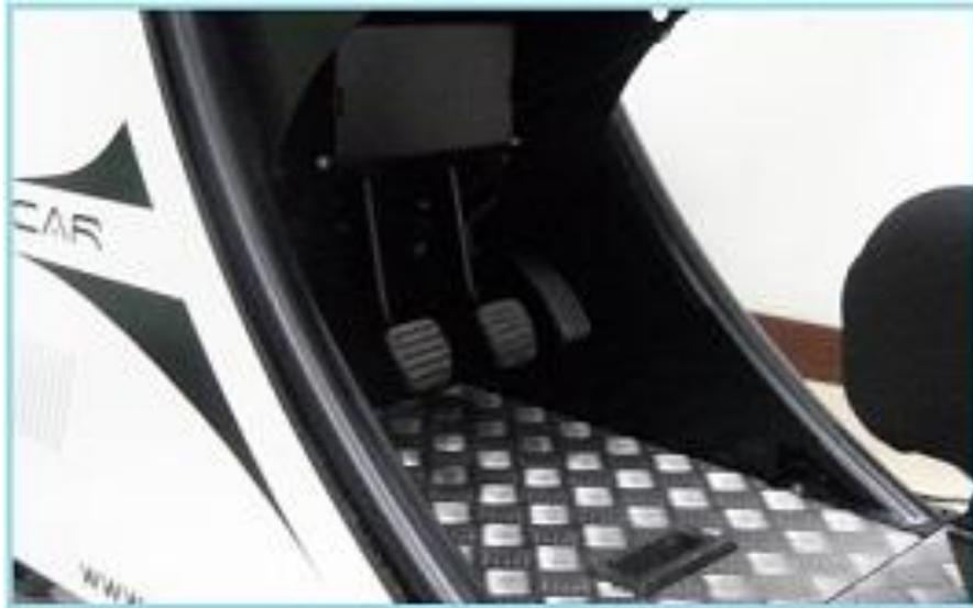
마찬가지로 장애유형에 따라서 발 대신에 손을 사용하는 등, 그 조작방법은 다르지만 차의 가속 및 감속과 엔진동력을 바퀴에 전달하기 위한 장치(클러치 또는 자동변속장치)를 사용해야 함으로 가속기, 브레이크, 클러치 또는 자동변속기에 가해지는 압력을 측정하여 운전능력을 평가합니다.
